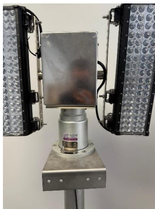
Sänk ned belysningsenheten och dra åt de 3 ställskruvarna
