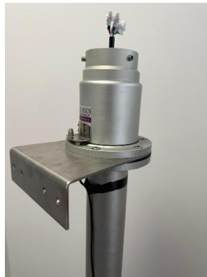
Riktig montering av monteringsplaten
