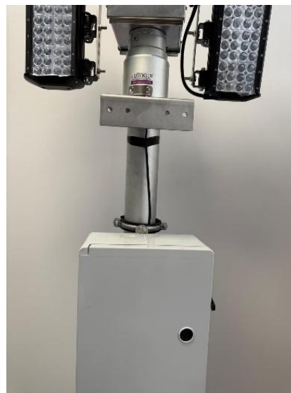
Riktig montering av koblingsboksen
