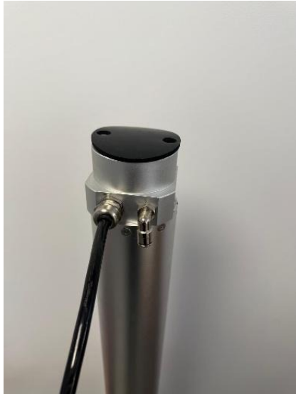
Inserire la guarnizione a piastra
