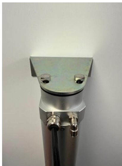
Fixation correcte du « support de fixation 2 »
