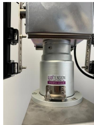
Montage correct du bloc d'éclairage
