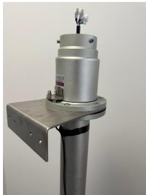
Fixation correcte de la plaque de montage
