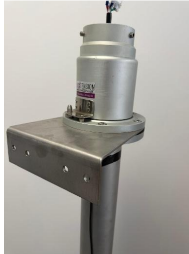
Fixation correcte de la plaque de montage
