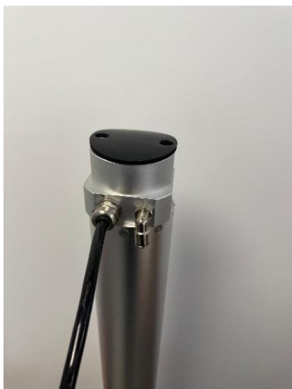
Mettez le joint de plaque en place
