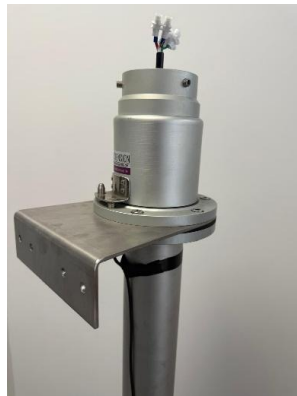
Fijación correcta de la placa de montaje
