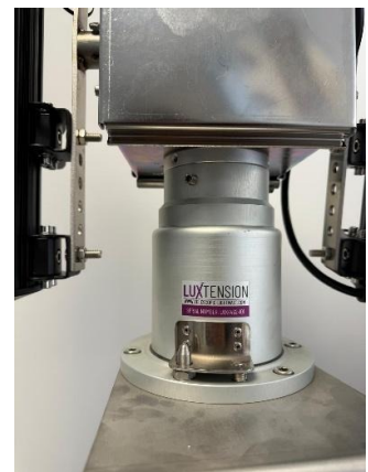
Montaje correcto de la unidad de iluminación
