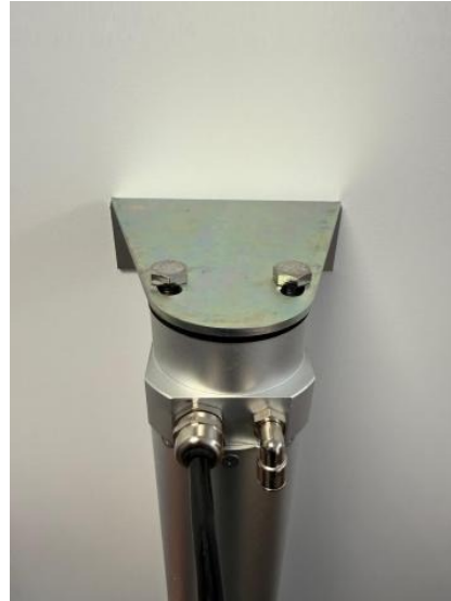
Fijación correcta del «soporte de montaje 2»
